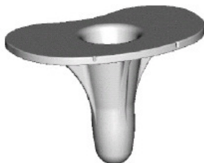
Fig. 7: Disco tibial e sua quilha monobloco, reforçada por três aletas.
